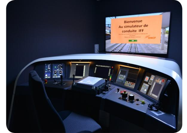
Le Simulateur de conduite multifonctionnel de dernière génération permet de reproduire les pupitres de conduite de plusieurs engins moteurs dans des **configurations variées** :
